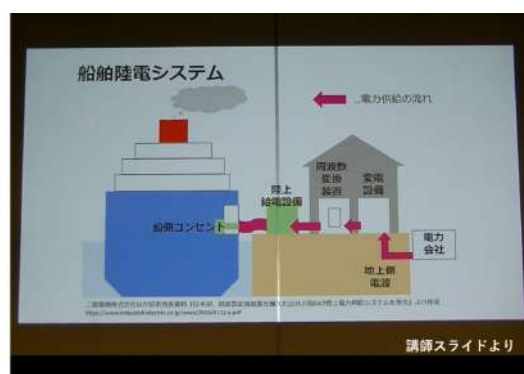
停泊中のCO2を削減する陸電システム
